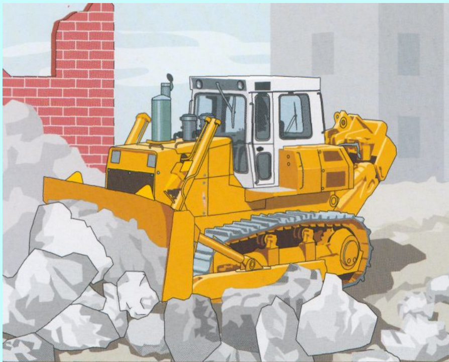
Прокладывание колонных путей и устройство проходов (проездов) в завалах
