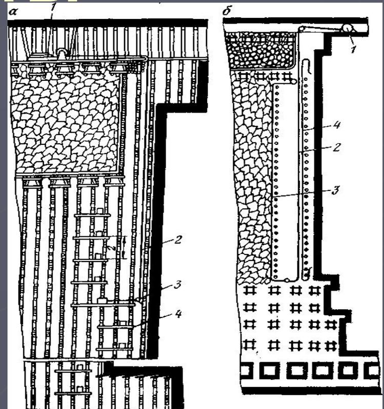
Рис. 8.2. Управление горным давлением полным обрушением на крутом пласте
