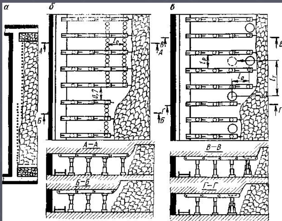
Рис. 8.1.. Управление кровлей полным обрушением на пологом пласте:
