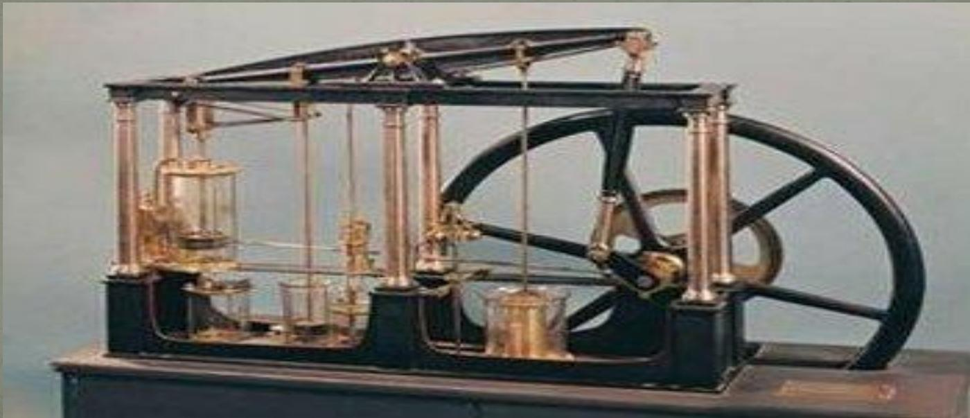
Следующее усовершенствование было направлено на то, чтобы заставить поршень в цилиндре совершать полезную работу не за счет атмосферного давления, а с помощью давления пара.
