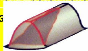
Прямые зубья разрушаются по сечению у основания зуба, косые - по наклонному сечению. Пломка является следствием действия повторно-переменных напряжений изгиба  $\sigma_f$  или перегрузки. Излом зуба может привести к весьма тяжким последствиям вплоть до разрушения валов и подшипников, а иногда и всего механизма.
