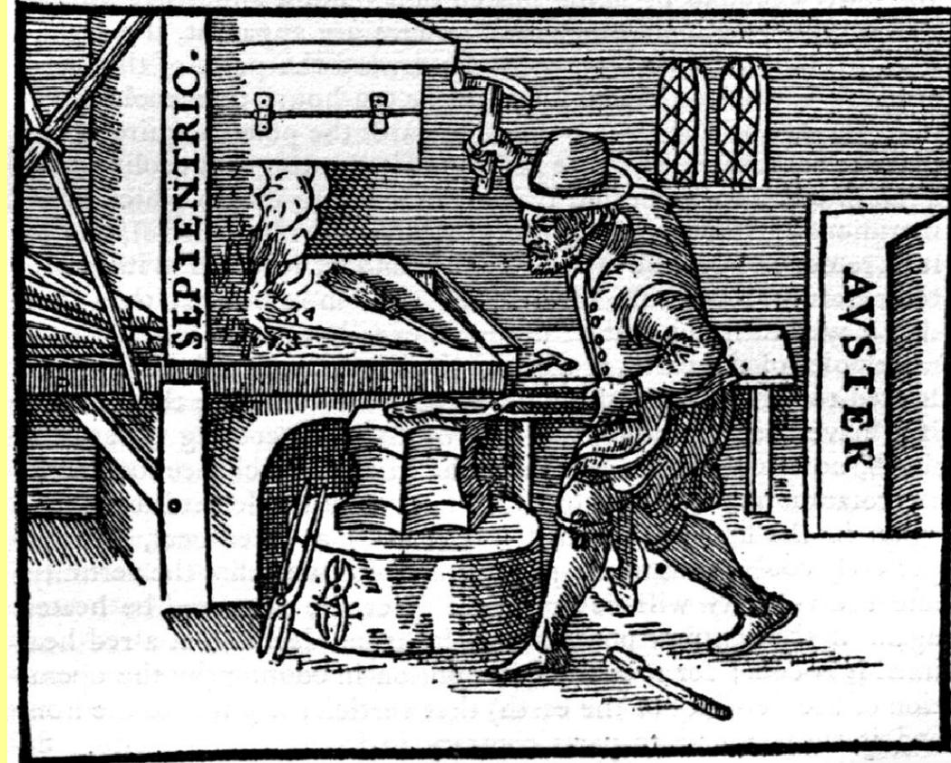
**Намагничивание железа при ковке,
