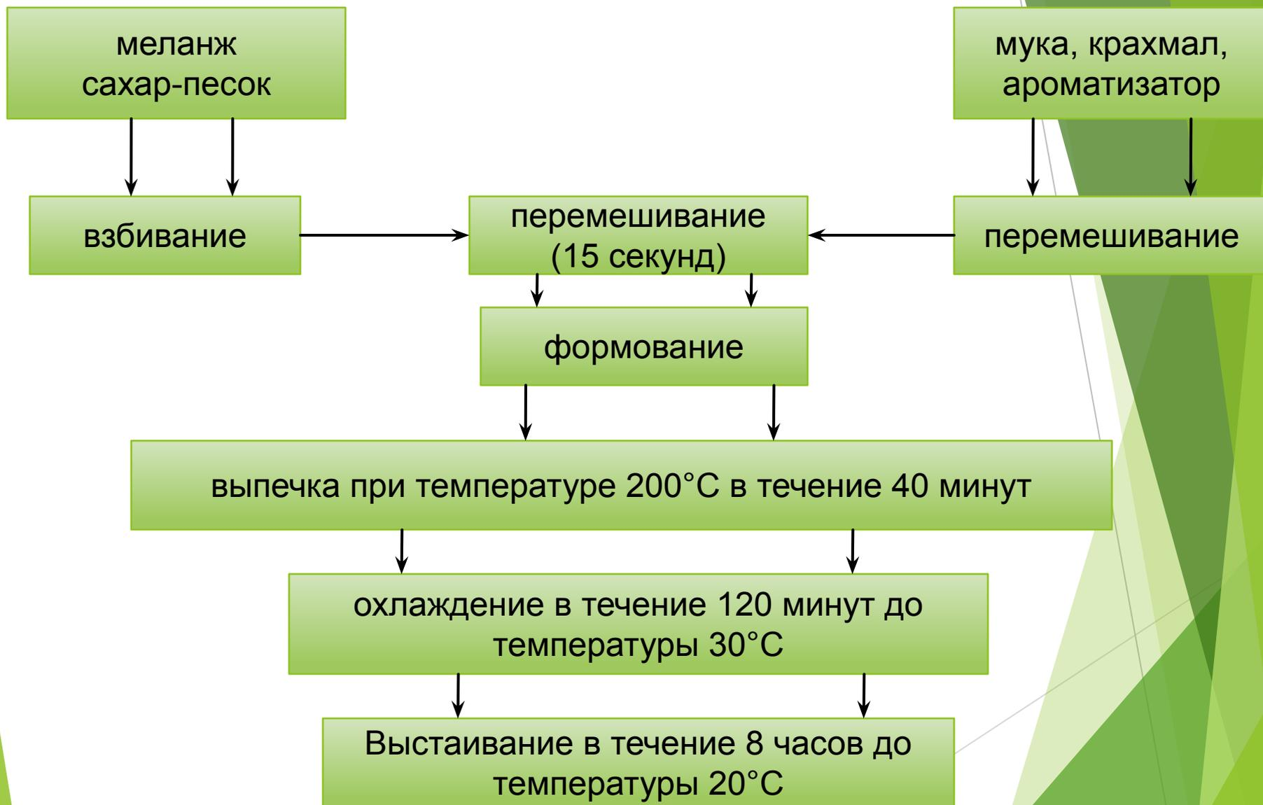
Рисунок 1 - Технологическая схема производства бисквитного полуфабриката
