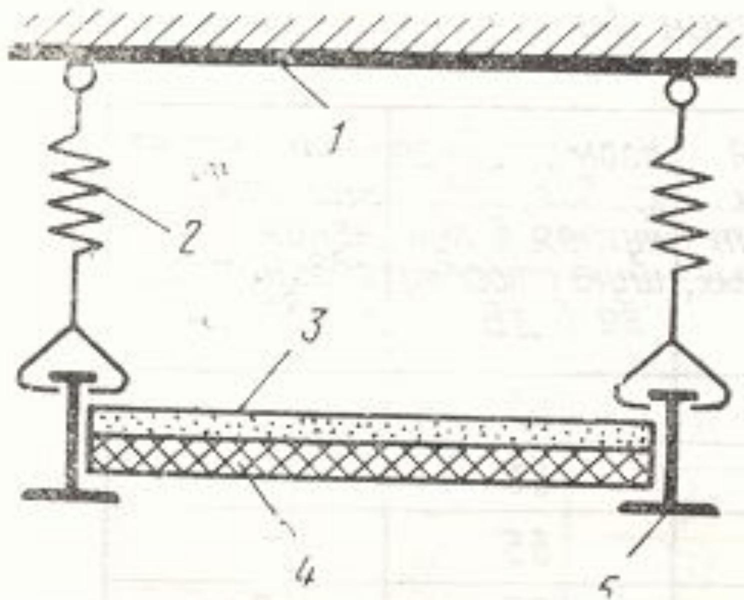
СХЕМА СИСТЕМЫ С ПРУЖИНЫМИ ЭЛЕМЕНТАМИ И ДЕМПФЕРИМИ
