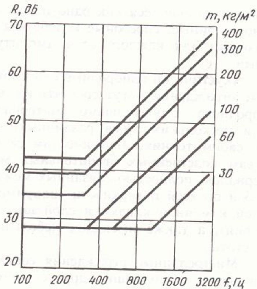
Рис. 8.28. Зависимость звукоизоляции  $R$  от частоты для стен с различ-
