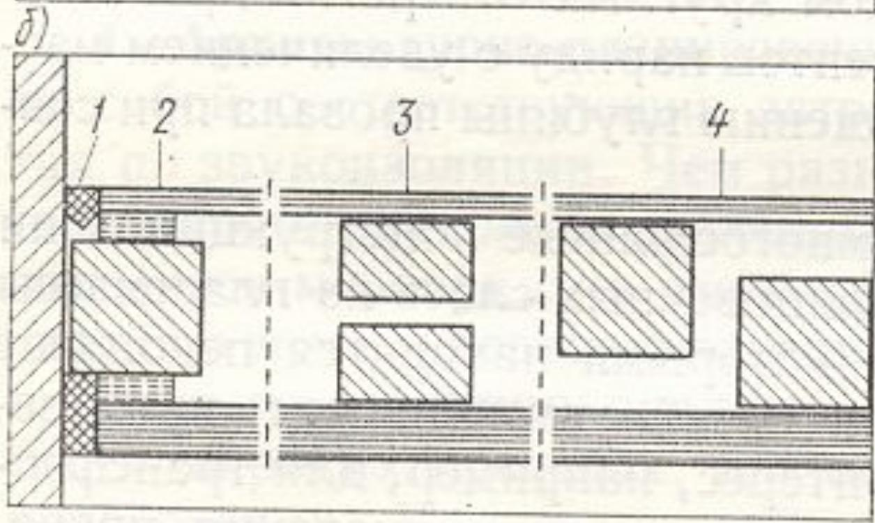
**Конструкции перегородок из листов гипсокартона на основе каркаса из деревянного бруса 50x100 мм расположены в порядке возрастания звукоизолирующей способности.**
