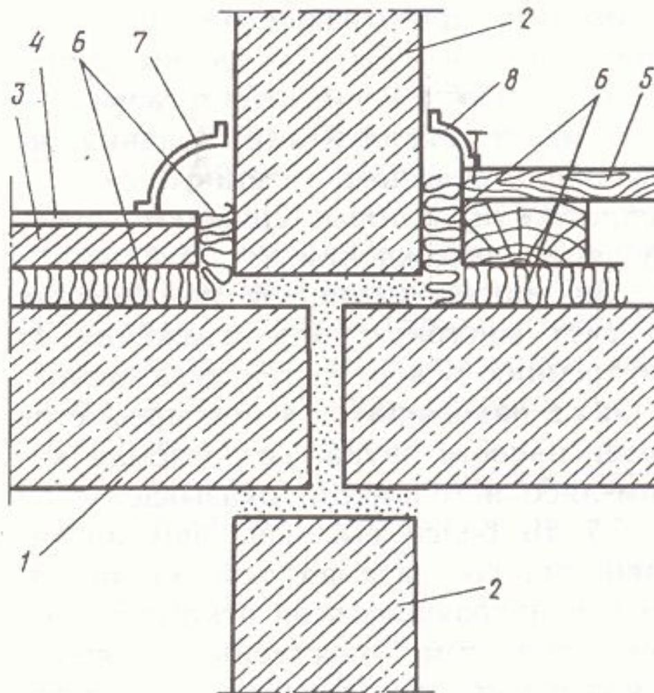
Рис. 8.32. Примыкание пола на звукоизоляционной прослойке к стене
