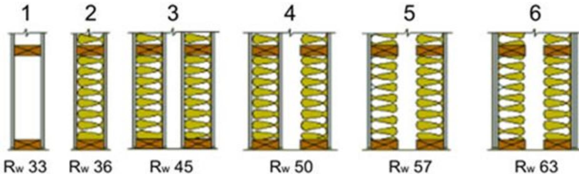
**Если внутри исходной перегородки (поз.5) закрепить один или два дополнительных слоя гипсокартона, мы разделим существующий воздушный промежуток на несколько более тонких сегментов (поз.4, поз.3). Несмотря на увеличение поверхностной массы перегородки, уменьшение воздушных промежутков значительно снизит звукоизоляцию на низких частотах, что приведет к общему уменьшению значения индекса изоляции воздушного шума  $R_w$ .**
