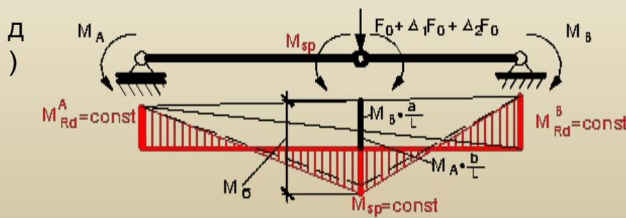
$$M_l + M_{\text{sup}}^A \cdot \frac{b}{L} + M_{\text{sup}}^B \cdot \frac{a}{L} = M_{\text{б}}$$
