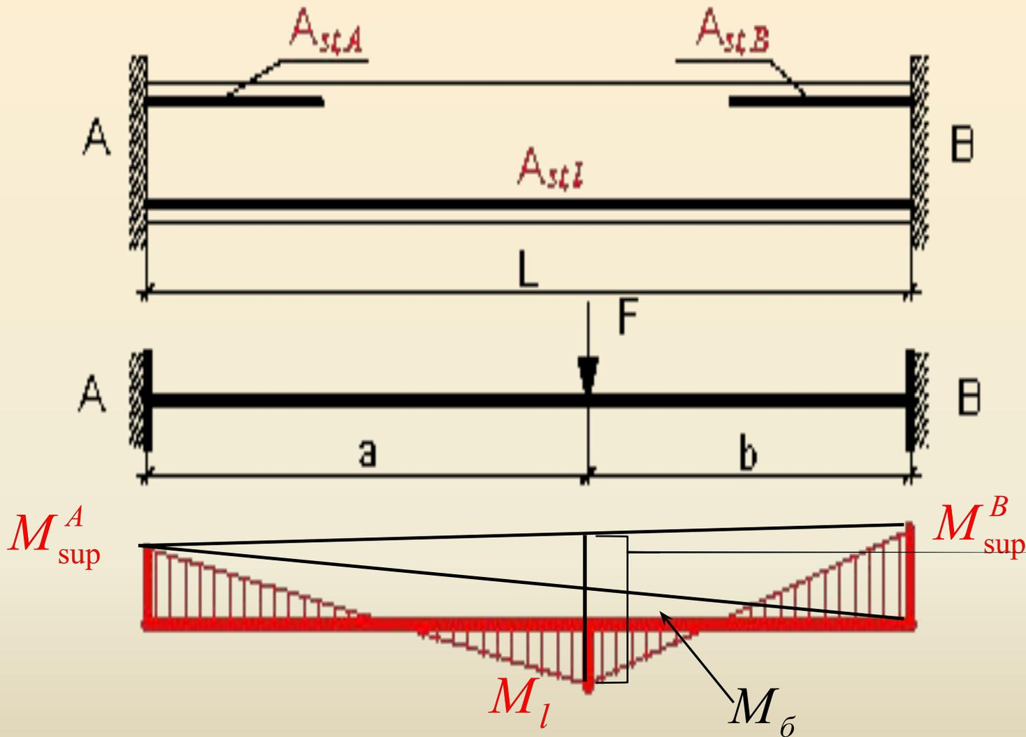
$$M_l + M_{sup}^A \cdot \frac{b}{L} + M_{sup}^B \cdot \frac{a}{L} = M_0 \quad \text{где } M_0 = F_0 \cdot \frac{a \cdot b}{L} \text{ — момент в балке на двух опорах}$$
