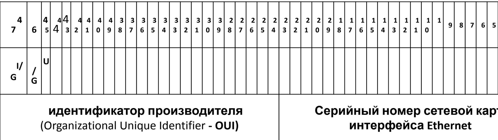
Рис 4-12.1-а) Структура МАС адреса в нотации IEEE 802.2
