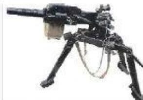
30-мм автоматический станковый гранатомет АГС-17 «Плазма»
