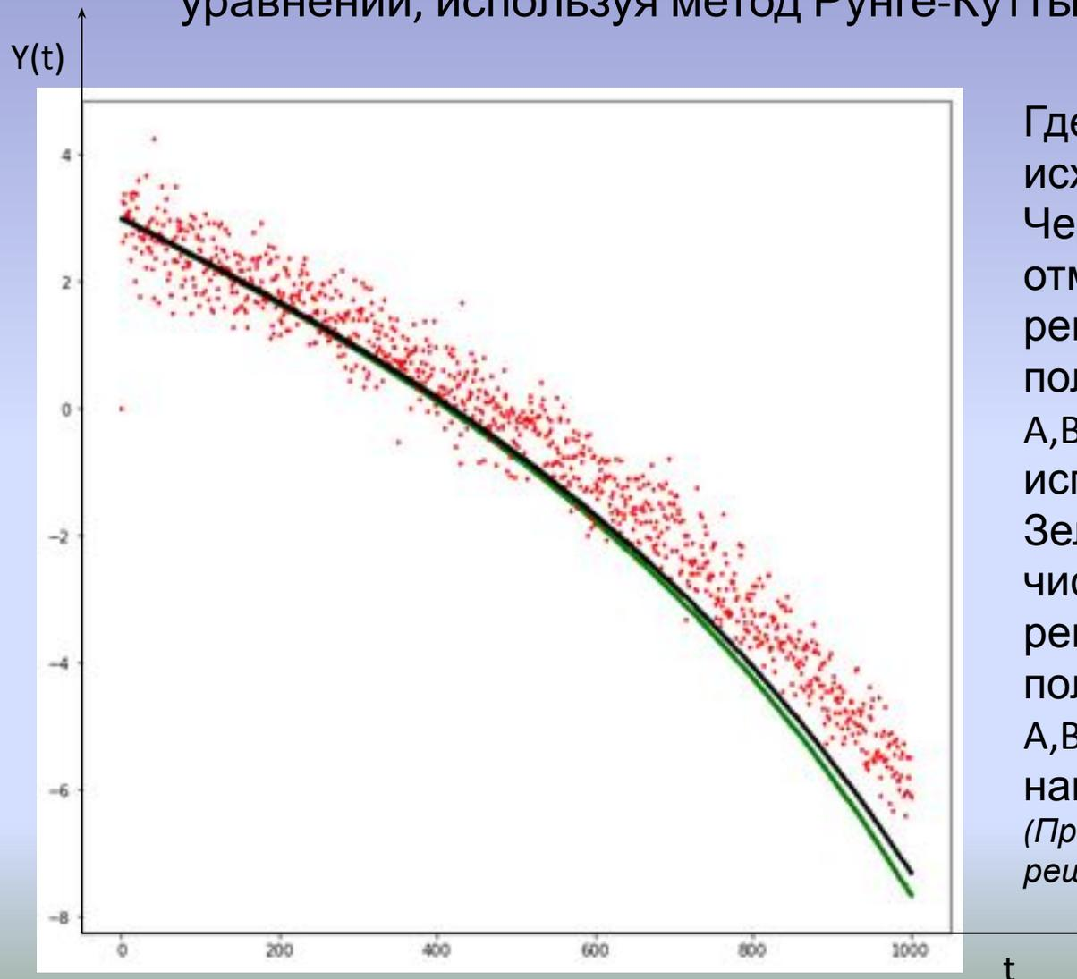
Где красным отмечены исходные данные  $y(t)$ . Черным цветом отмечено численное решение с использованием полученных параметров  $A, B, C, D$  из метода с использованием ML. Зеленым цветом отмечено численное решение с использованием полученных параметров  $A, B, C, D$  из метода наименьших квадратов (Предполагается еще кривая из решения К-Р аппроксимации)
