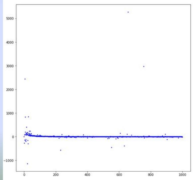
Наблюдаемые отклонение имеют грубые промахи, которые явно обусловлены шумом и далеки от найденного параметр. Отсеивая промахи, получаем:
