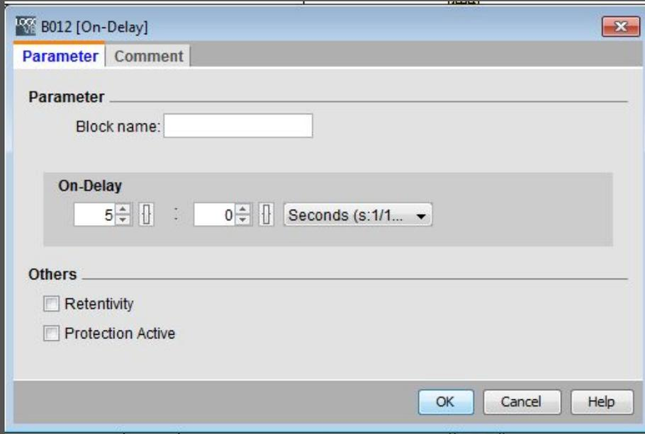
В свойствах блоков «Задержка включения» выставляем временные параметры.
