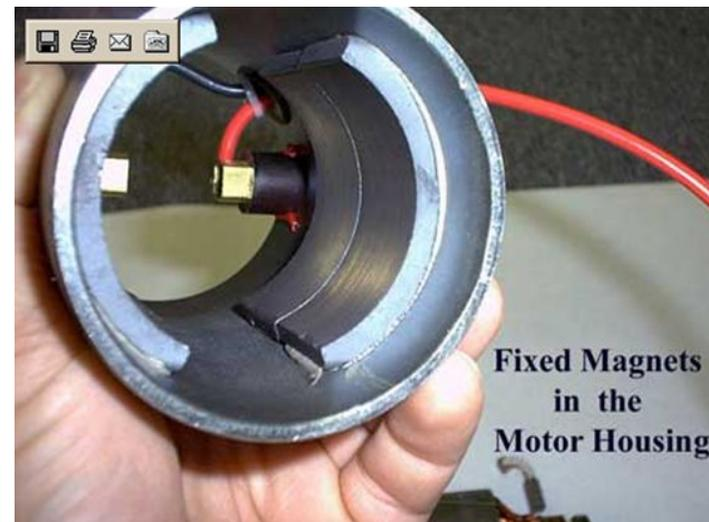
Статор – неподвижная часть мотора, оснащенная фиксированными магнитами. Это самая тяжелая часть любого мотора роторного типа.
