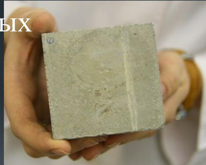
**Водонепроницаемость - это свойство раствора не пропускать через себя воду. Степень водонепроницаемости зависит в основном от пористости раствора.**
