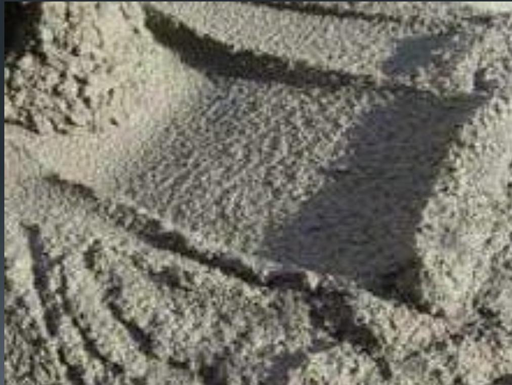
**Жирными** называют растворы с избытком вяжущего. Такие растворы пластичны, но при твердении могут потрескаться и дают большую усадку.
