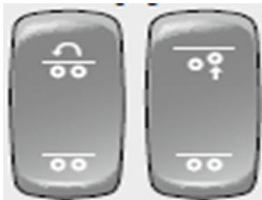
**Клавиши перераспределения нагрузки по осям**
