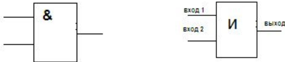
На выходе этого элемента будет сигнал 1 только в том случае, когда на все входы поступает сигнал 1. Когда хотя бы на одном входе будет ноль, на выходе также будет ноль.
