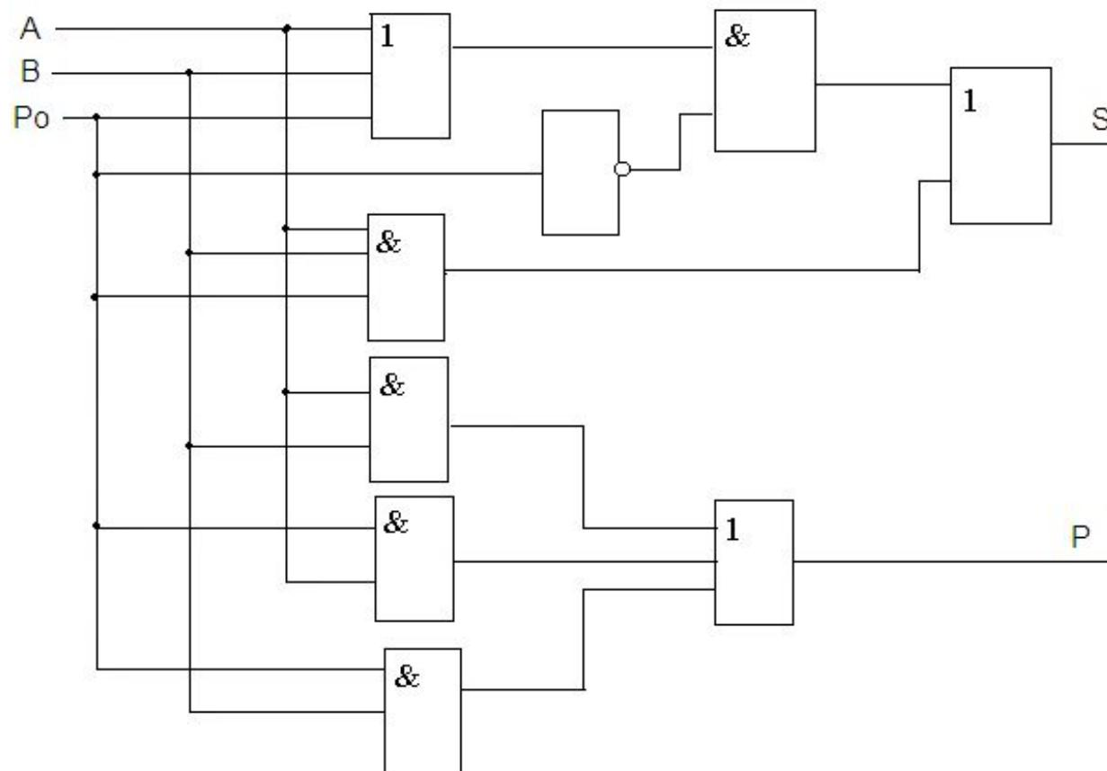
**Сумматор** - это электронная логическая схема, выполняющая суммирование двоичных чисел поразрядным сложением. Сумматор является центральным узлом арифметико-логического устройства процессора. Находит он применение и в других устройствах компьютера. В реальных электронных схемах сумматор изображается так:
