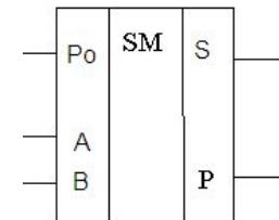
Сумматор выполняет сложение *многозначных двоичных чисел*. Он представляет собой последовательное соединение *одноразрядных двоичных сумматоров*, каждый из которых осуществляет сложение в одном разряде. Если при этом возникает переполнение разряда, то перенос суммируется с содержимым старшего соседнего разряда.
