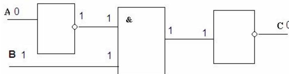
Рассмотрим третий вариант входных сигналов:  $A=1$ ,  $B=0$ . Проследим по схеме, как проходят и преобразуются входные сигналы. Результат, полученный на выходе ( $C=1$ ), запишем в таблицу.
