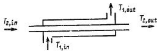
Рис. 2. Схема теплообменника с параллельным однонаправленным движением теплоносителей
