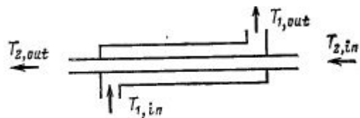
Рис. 1. Схема противоточного теплообменника
