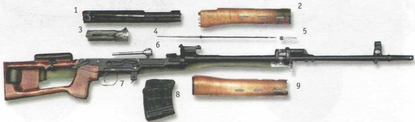
Неполная разборка СВД : 1 — крышка ствольной коробки с возвратным механизмом; 2 — верхняя ствольная накладка; 3 — затворная рама; 4 — толкатель; 5 — газовый поршень; 6 — затвор; 7 — ствольная коробка со стволом и прикладом; 8 — магазин; 9 — нижняя ствольная накладка.
