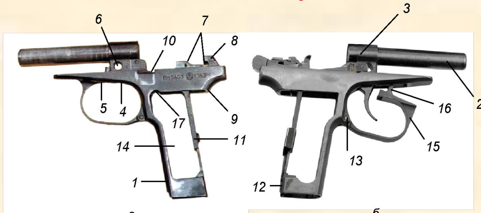
*а* Рамка со стволом и спусковой скобой: *б*
