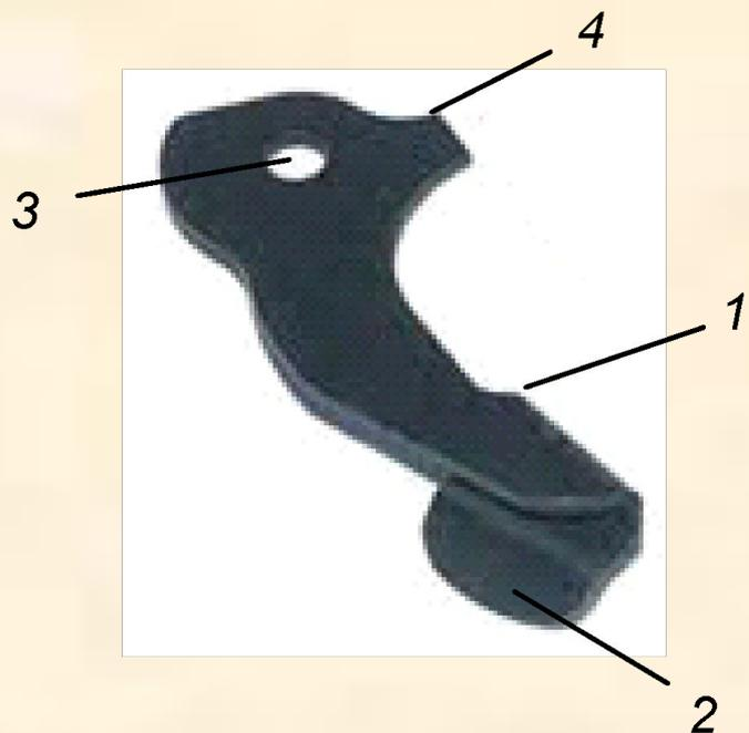
1 – выступ; 2 – кнопка с насечкой; 3 – отверстие; 4 – отражатель
