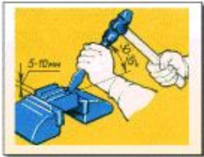
Срубание слоя металла на широкой плоской поверхности
