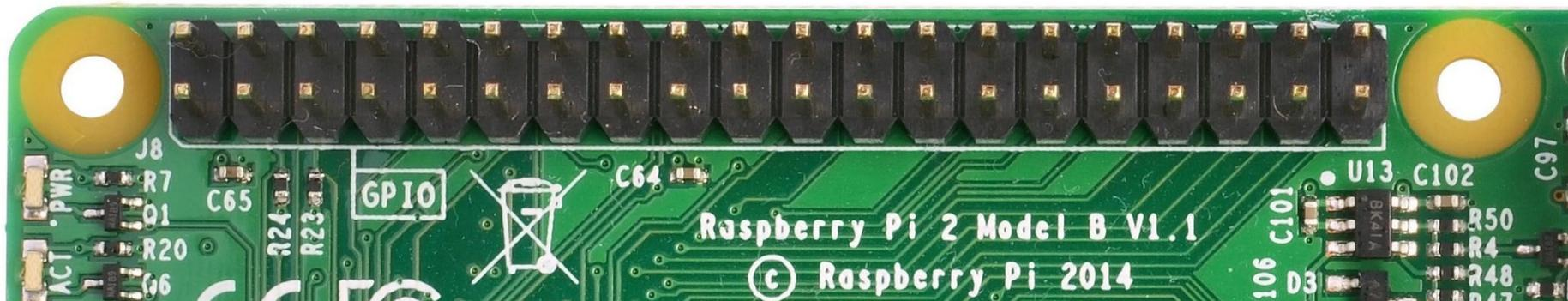
Порт **GPIO** (сокращение от *General Purpose Input Output*) - это программно управляемые выходы общего назначения, которые могут работать как входы (для считывания сигнала) или как выходы (для передачи сигнала).
