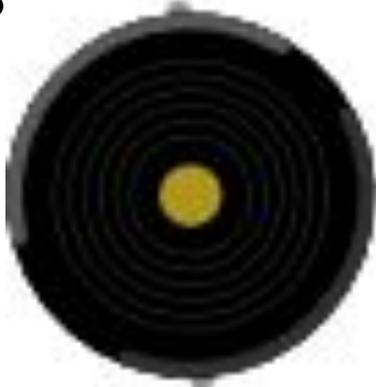
Полярность пьезопищалки роли не играет: вы можете подключать любую из ее ножек к земле, любую к порту микроконтроллера
