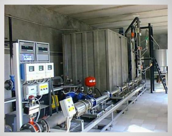
Механическая измерительная установка с одной испытательной линией предназначена для поверки счетчиков холодной воды
