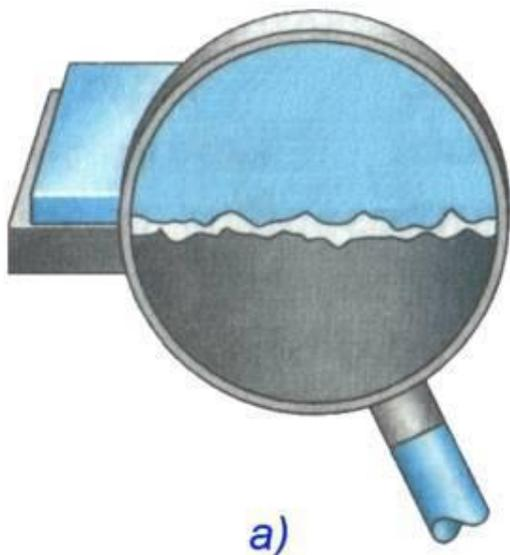
Трение между соприкасающимися твёрдыми телами (без смазки) называют **сухим трением** (рис. а)
