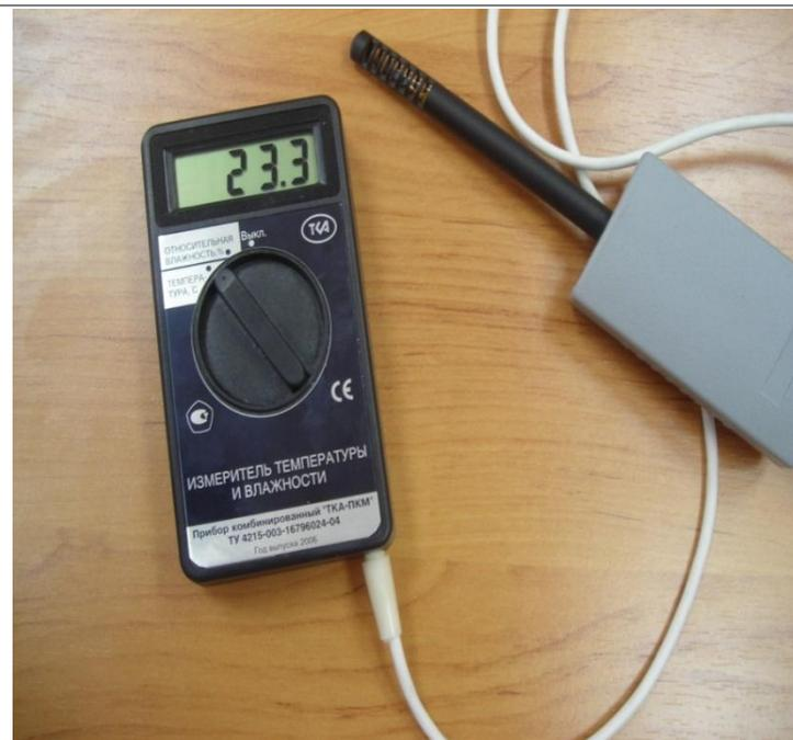
Прибор для измерения температуры и влажности воздуха
