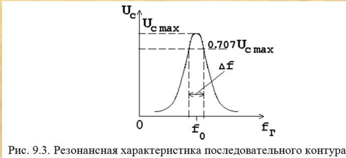
Полоса частот, в пределах которой колебания в контуре поддерживаются на определенном уровне, называется полосой пропускания.
