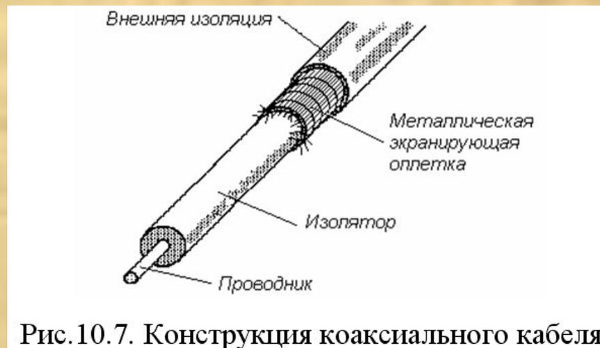
Рис.10.7. Конструкция коаксиального кабеля
