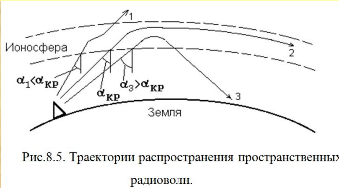
Степень преломления радиоволн зависит от угла падения радиоволны на ионосферу  $\alpha$  с поверхности Земли и частоты колебаний  $f$ . При этом возможны различные траектории распространения пространственных радиоволн в зависимости от величины угла падения  $\alpha$
