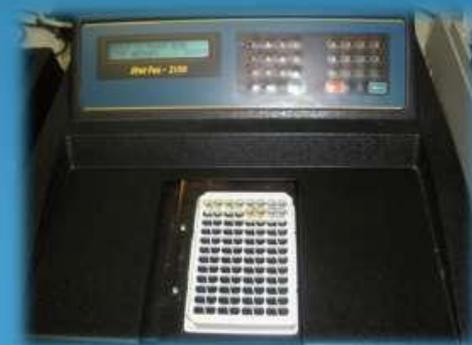
Stat Fax 2100 измеряет оптическую плотность раствора.
