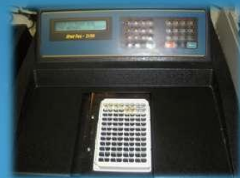
Stat Fax 2100 измеряет оптическую плотность раствора.
