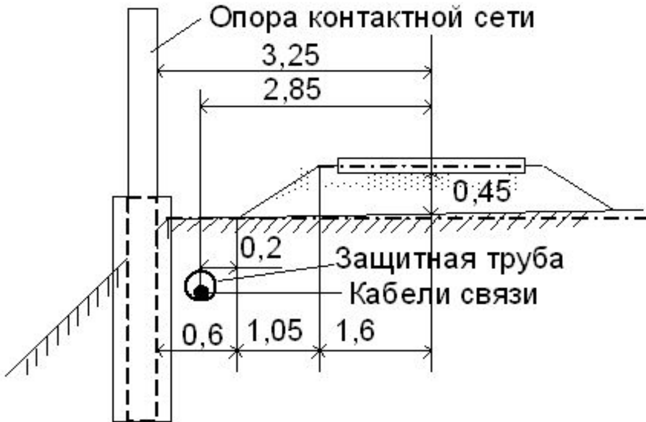
Рисунок 3 – Прокладка кабеля между опорами контактной сети и рельсами
