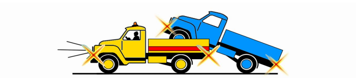
Буксировка методом частичной погрузки
