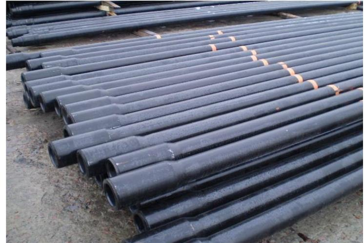
**Хвостовик** – обсадная колонна потайного типа, которая устанавливается в специальной системе подвески в предыдущей обсадной колонне («внахлест» на 20-50 м). Хвостовик может как цементироваться, так и не цементироваться, что обусловлено в первую очередь прочностью пород разрабатываемого пласта-коллектора.
