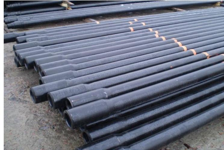
**Промежуточную обсадную колонну** спускают в случае необходимости после кондукторной для крепления неустойчивых пород, разобщения зон осложнений, зон несовместимых по условиям бурения и водоносных горизонтов.
