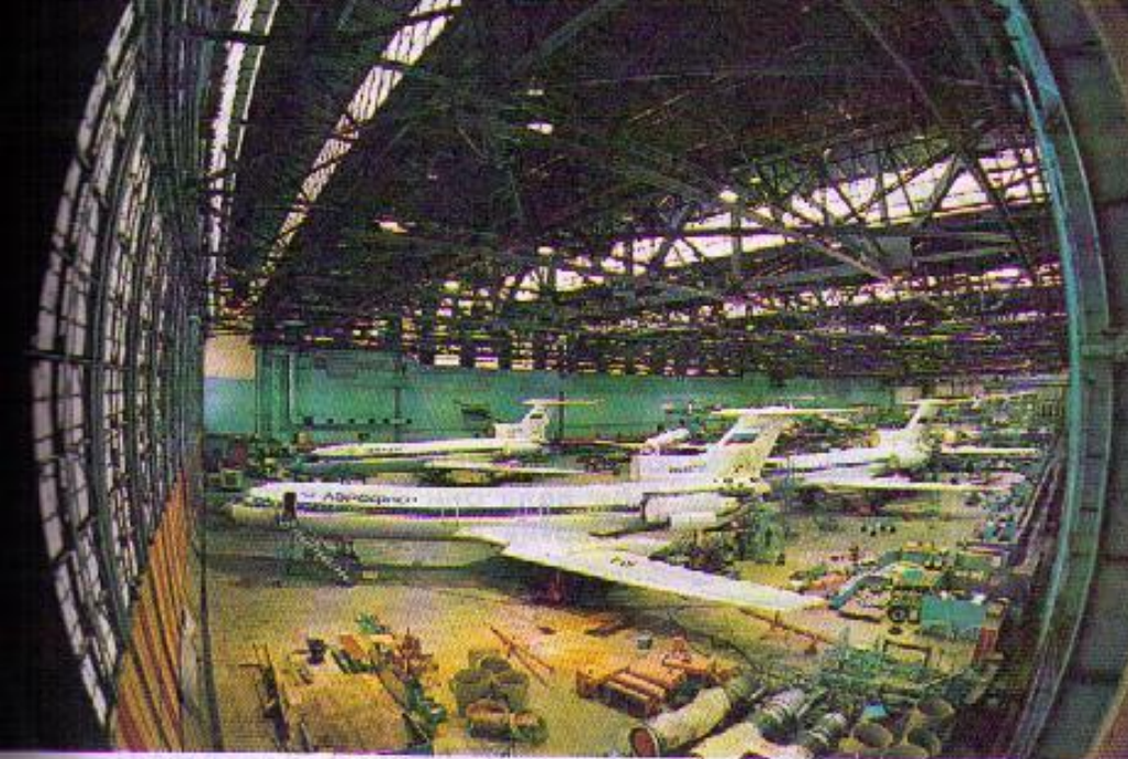
13. Сборка самолетов Ту-154М на авиазаводе в г. Самаре
