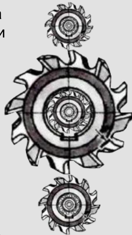
**Долбление** — вид механической обработки металлов резанием, при которой инструмент (долбляк) совершая возвратно-поступательные движения, срезает обрабатываемый материал. Долбление очень близко к другому виду обработки материалов резанием, строганию.
