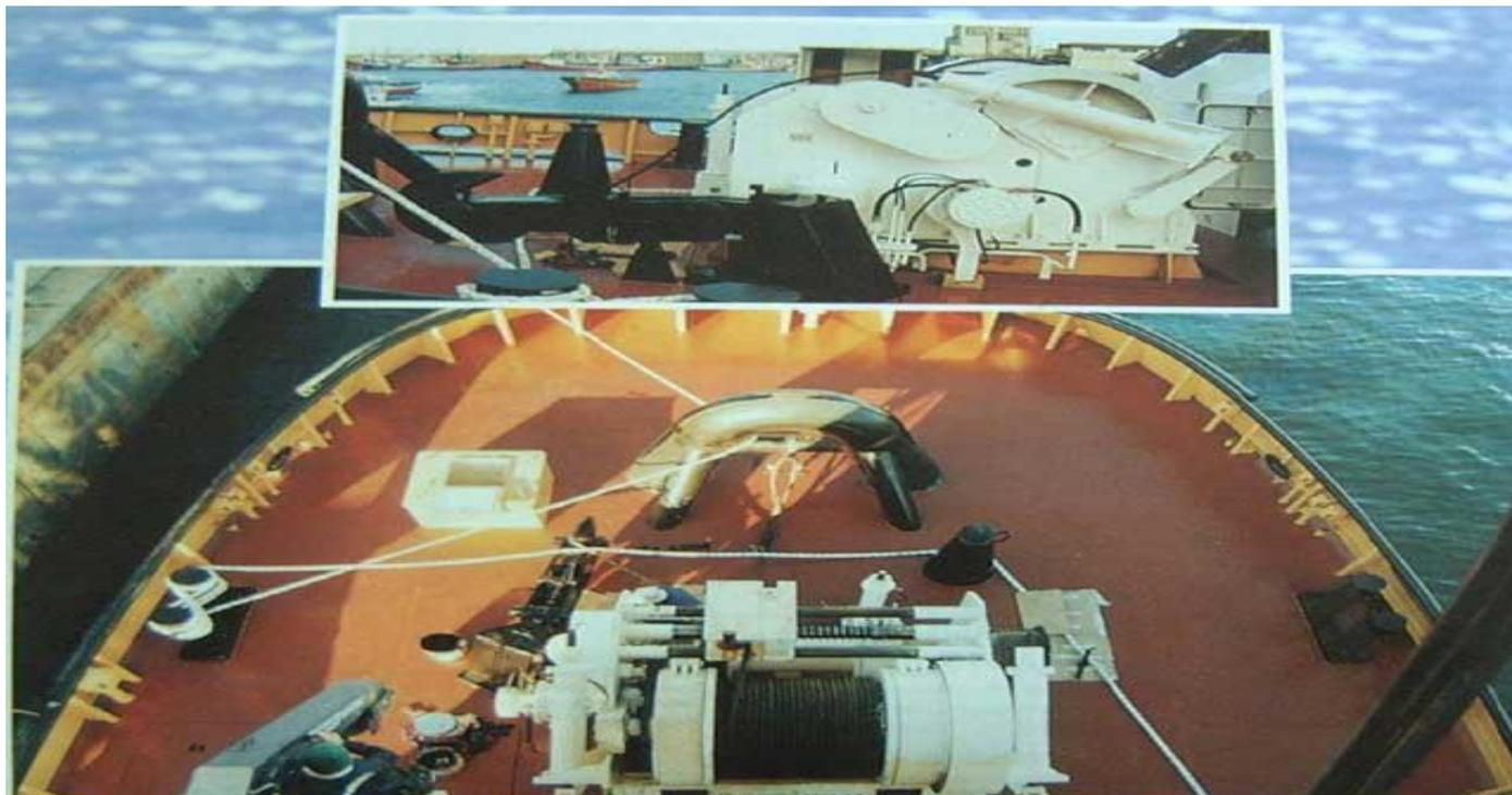
**Буксирные лебедки** с электрическими или гидравлическими приводами имеют автоматические регуляторы натяжения троса и тросоукладчики (рис). Буксирный трос закреплен на барабанах лебедки, которая обеспечивает постоянную буксирную тягу и автоматически потравливает или подбирает трос в случае превышения или снижения установленной тяги.
