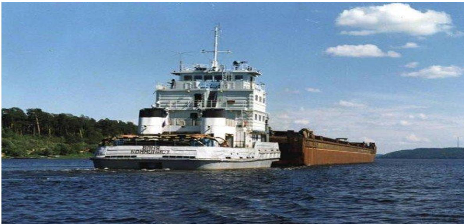
**Буксировка толканием** – при котором буксир толкач (со специальным приспособлением у форштевня), упираясь в корму буксируемого объекта, движет его вперед .
