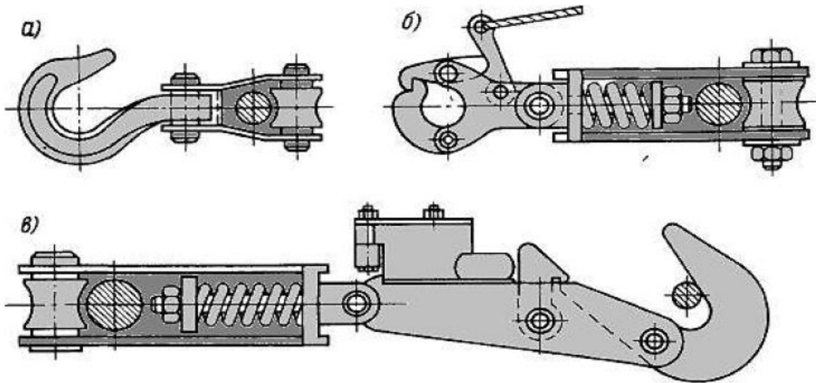
**Буксирные гаки** предназначены для крепления огона буксирного троса, и имеют устройство для быстрой отдачи буксирного конца в случае угрозы разрыва троса. Буксирные гаки бывают **простыми** (рис. а), недостатком этого гака является, то, что для отдачи буксирного троса необходимо дать ему некоторую слабину. **Полуавтоматические и автоматические буксирные гаки** (рис. б и в) имеют устройства, позволяющие немедленно отдать буксирный трос.
