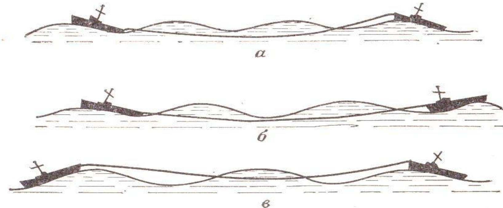
Длину буксирного троса рекомендуется брать с расчетом, чтобы оба судна одновременно всходили на волну, т. е. длина буксирного троса должна быть кратной длине волны (рис ).
