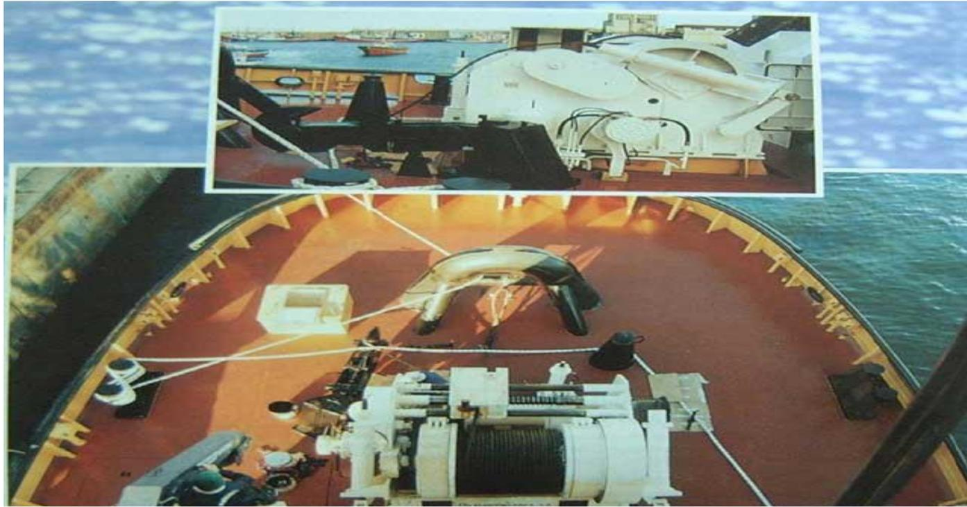
**Буксирные арки** – это металлические дуги установленные поперек кормовой палубы буксира. Они предназначены для защиты людей и палубных устройств от повреждений буксирным тросом.
