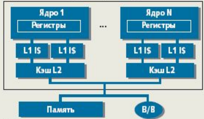
г) Многопоточная многоядерная архитектура с общей кэш-памятью
