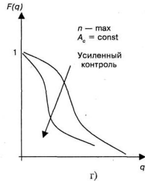
Рис. 13.3. Типичные оперативные характеристики планов приемочного контроля
