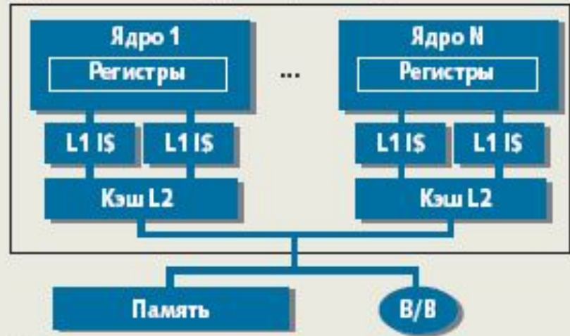
г) Многопоточная многоядерная архитектура с общей кэш-памятью
