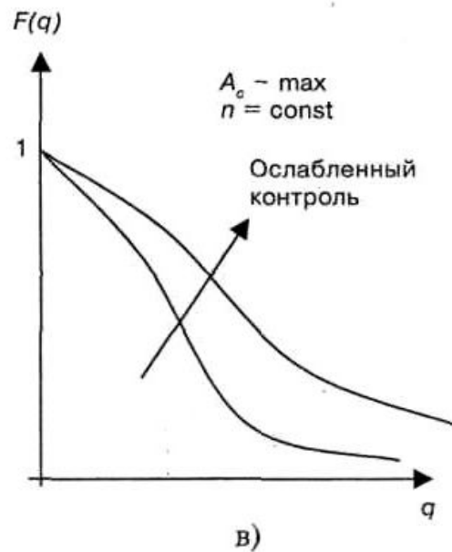
Рис. 13.3. Типичные оперативные характеристики планов приемочного контроля
