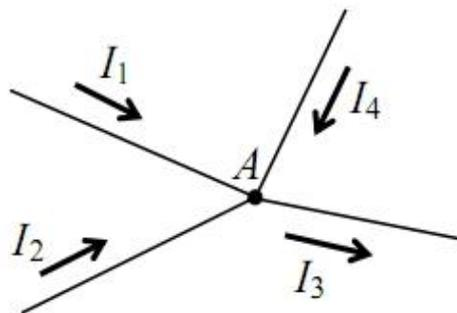
*Первое правило Кирхгофа:* алгебраическая сумма токов, сходящихся в узле разветвленной электрической цепи, равна нулю:
