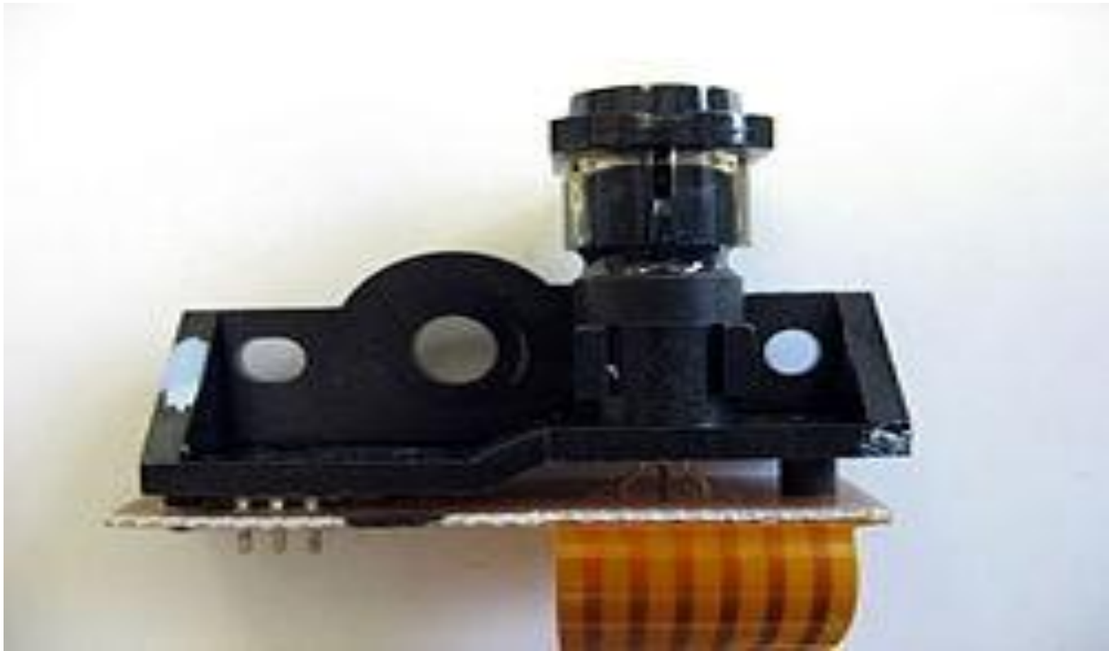
Полупроводниковый лазер , применяемый в узле генерации изображения принтера Hewlett-Packard
