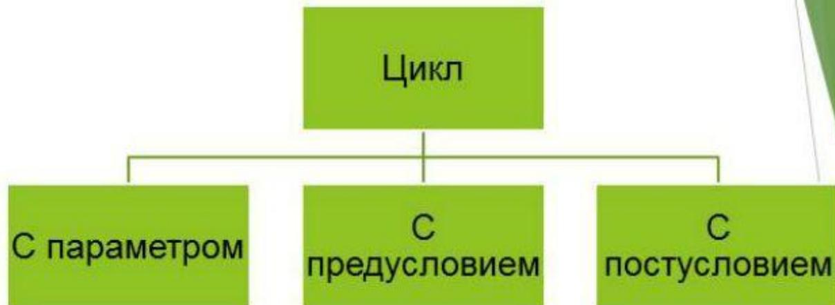
*В цикле с параметром число повторений цикла однозначно определено и задается с помощью начального, конечного значений параметра и шагом его изменения.*
