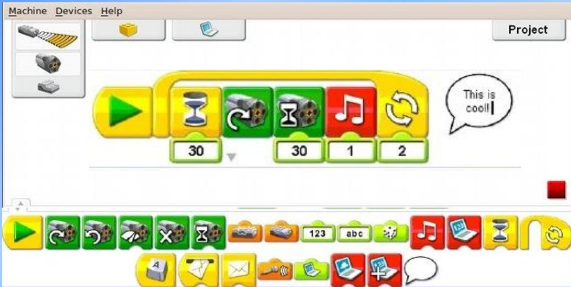
В LEGO WeDo блоки команд находятся в нижней части экрана.
