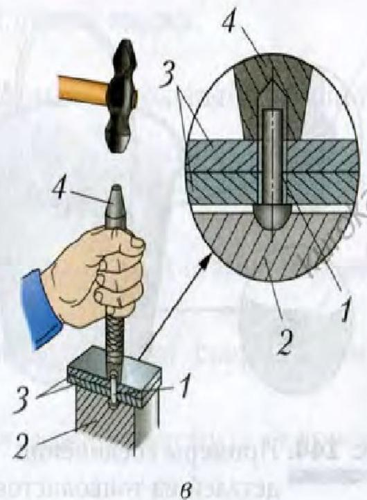
Рис. 147. Последовательность получения заклёпочного соединения:
