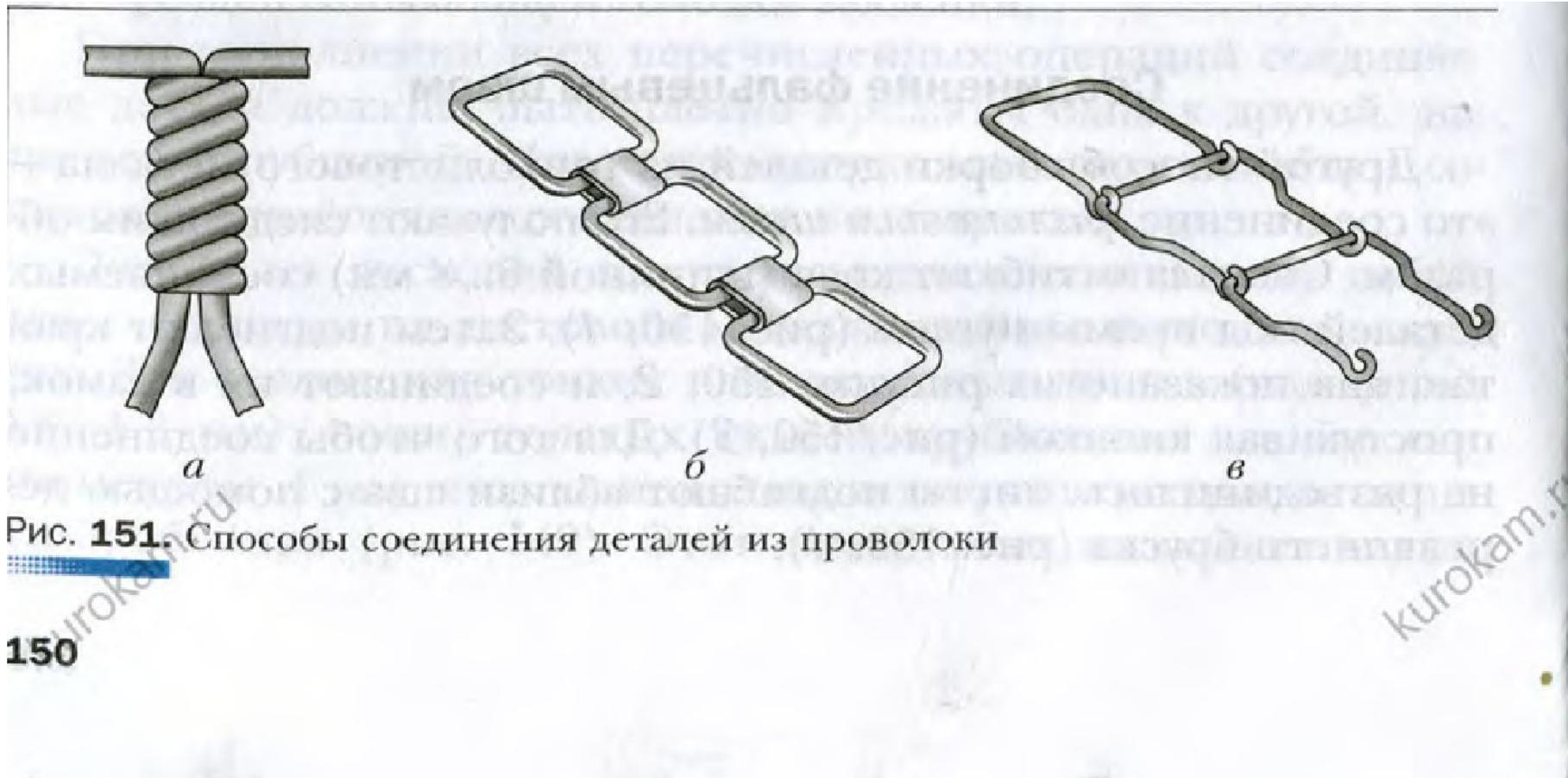
Рис. 151. Способы соединения деталей из проволоки
