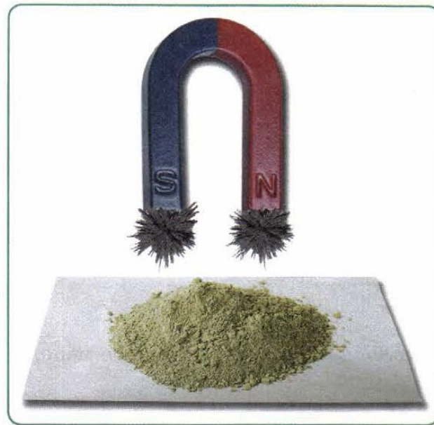
Рис. 27. Разделение смеси железных опилок и порошка серы с помощью магнита
