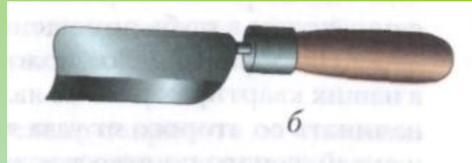
б — нож для разрезки трещин
