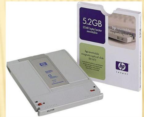
У этих дискет одна рабочая поверхность, их размер соответствует размеру обычной 3,5-дюймовой дискеты, однако они несколько толще. Так же, как и обычный флоппи-диск, магнитооптические диски снабжены окошком защиты записи.
