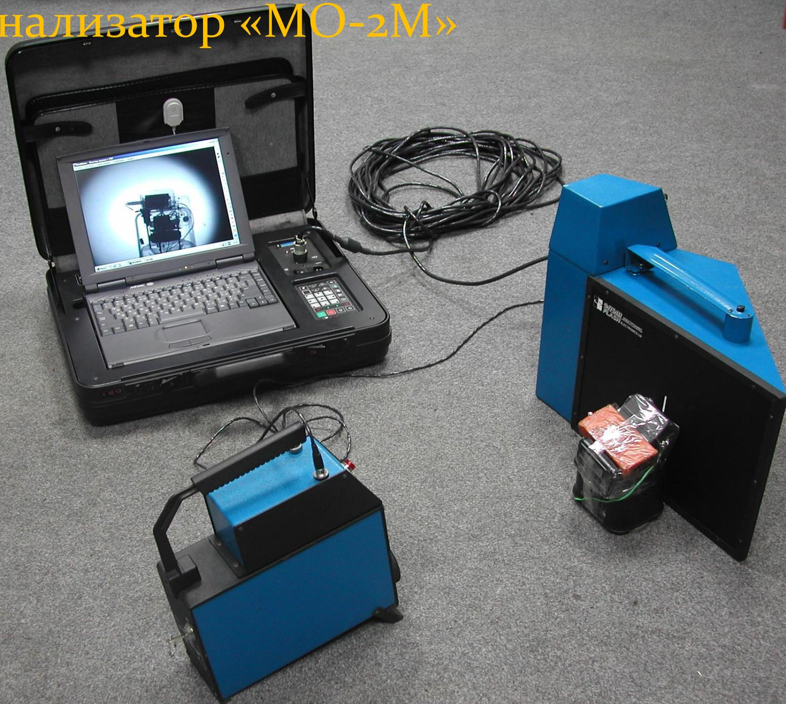
Отбор паров и частиц ВВ от контролируемого объекта производится воздушными насосами, действующими по принципу пылесоса. В портативных детекторах (например, EVD-3000) этот узел встроен в анализатор и дает оператору возможность свободно манипулировать им.
