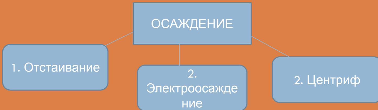
Отстаивание – процесс разделения неоднородных жидких или газообразных систем в результате выделения твердых или жидких частиц под действием гравитационной силы (силы тяжести).
