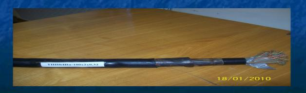
Кабель телефонный, с кордельно-полистерольной изоляцией, жил в алюминиевой оболочке, с защитным покровом из полиэтиленового шланга.
