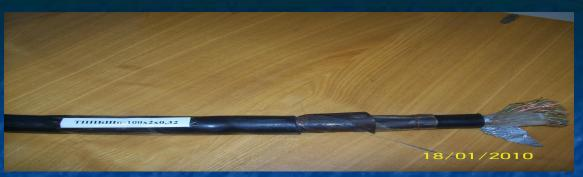
Кабель телефонный на 100 медных пар с диаметром жилы 0,32 мм. Сплошная полиэтиленовая изоляция жил, в полиэтиленовой оболочке, бронированный двумя стальными лентами, с защитным шлангом из полиэтилена.
