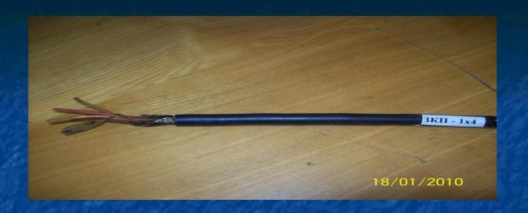
Зоновый кабель, с полиэтиленовой изоляцией и полиэтиленовой оболочкой. Состоит из медных жил, диаметром 1,2 мм, изолированных сплошным полиэтиленом толщиной 1,1 мм. Изолированные жилы скручиваются с шагом 150-300 мм.
