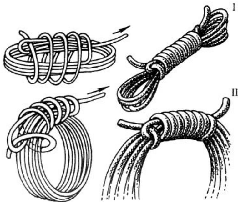
Рис. 15. Маркировочный узел.
