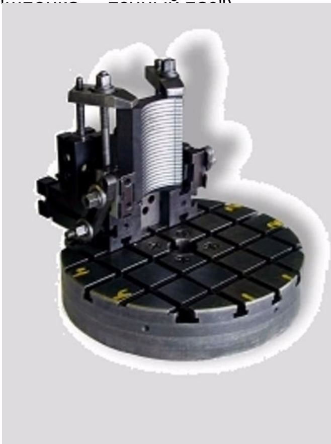
Рис. 1.14. Базовый набор деталей и сборочных единиц универсально-сборных приспособлений:
