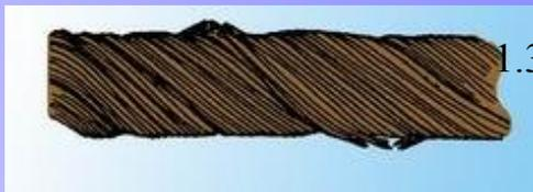
1.3. Сочетание обрывов проволок с их износом в канате односторонней свивки.
