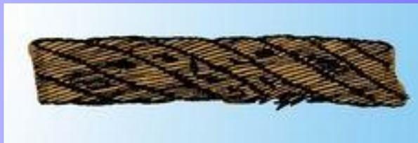
1.5. Обрыв проволок в зоне уравнильного блока в двух прядях в сочетании с местным износом.
