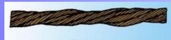
При уменьшении диаметра каната в результате повреждения сердечника — внутреннего износа, обмятия, разрыва и т. п. (на 3% от номинального диаметра у некрутящихся канатов и на 10% у остальных канатов) канат подлежит браковке даже при отсутствии видимых обрывов проволок.
