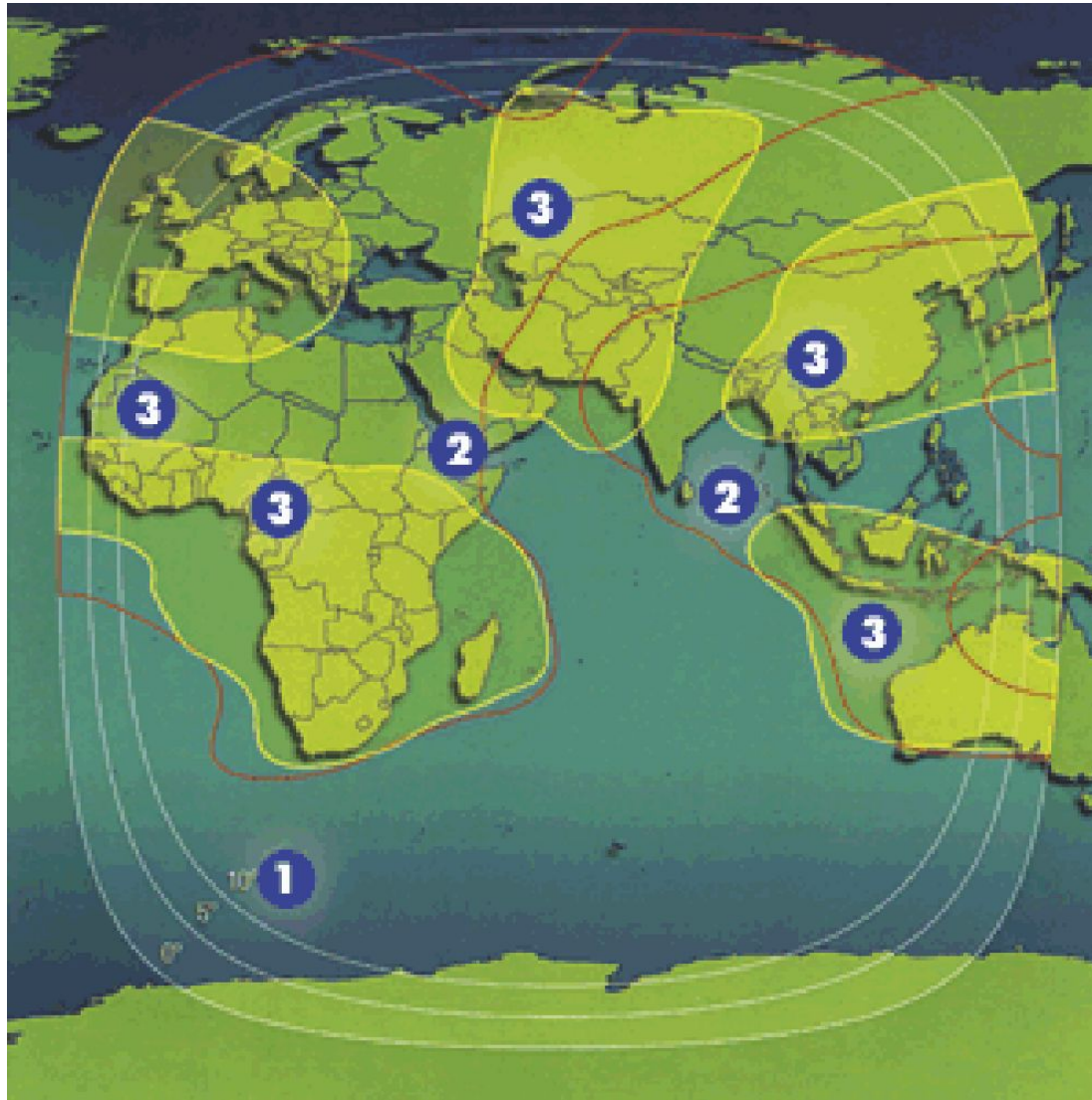
Рис. 7.2.2. Зоны покрытия, С-диапазон 1. Глобальный луч, 2. Полуглобальный луч, 3. Зоновые лучи
