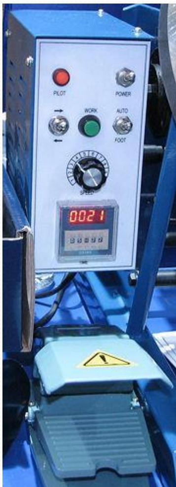
Блок управления сварочным позиционером с возможностью установки времени вращения по таймеру
