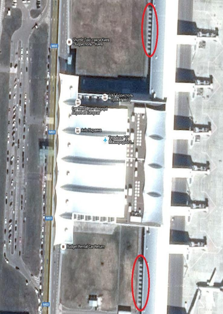
Розташування конденсаторних блоків холодильних машин терміналу «D»
