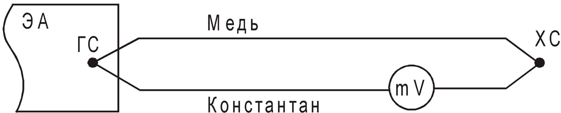
Измерение температуры с помощью термопары
