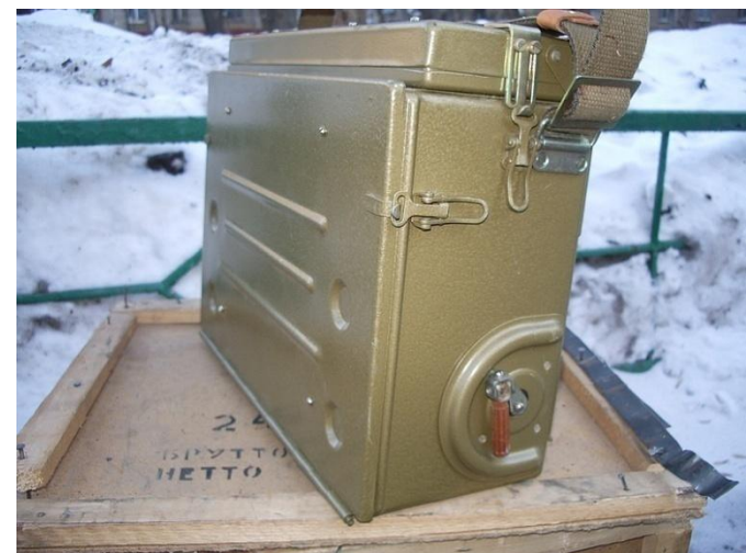
Полевой телефонный коммутатор П-193М
